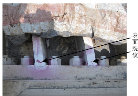
图3 辅钢结构支撑板角焊缝缺陷示例
