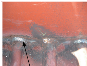
(b) 焊缝中间穿孔
