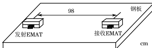
图 5 曲折线圈 EMAT 的位置分布示意
