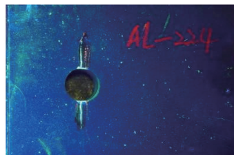
图7 224号试样打磨区域超声波清洗后的荧光渗透检测结果
