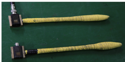
图 5 装机状态下检测叶片所用探头夹具外观照片
