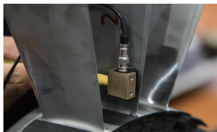
图 6 装机状态下对比试块叶盆刻槽检测照片
