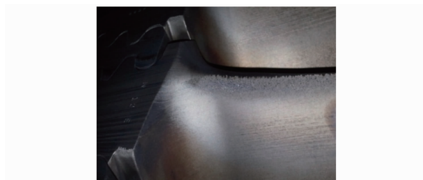
图2 某汽轮机末级叶片根部水蚀形貌
