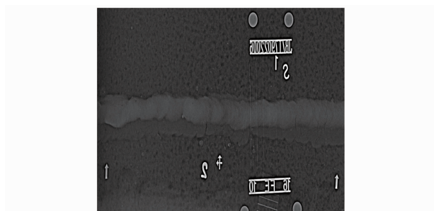
图9 S1 管管对接试样 2# 部位 DR 数字成像
