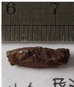
(b) 屏过联箱管口氧化铁渣
