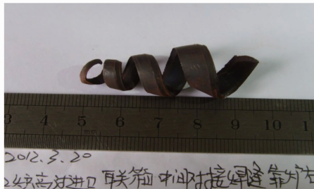
(c) 高过联箱管口内机加工铁屑
